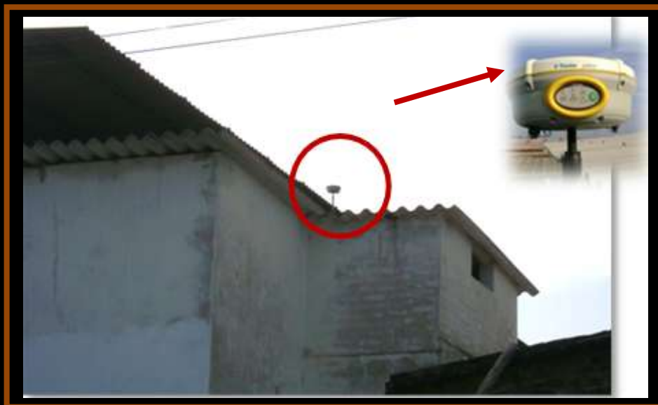
Estación de Referencia Fija GPS Chulucanas
